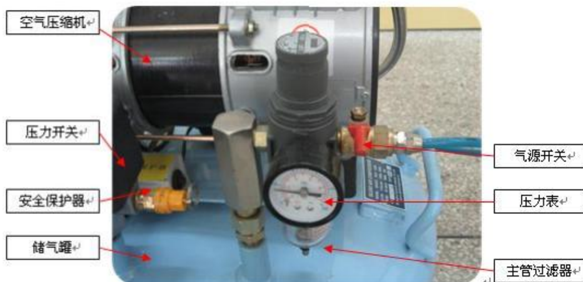
图 2-45 气泵上的元件介绍
